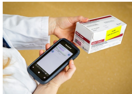
Kuva 1. Kannettava keräilylaitemallisto Honeywell Dolphin -malleja ja lääkkeen viivakoodin tunnistus.
