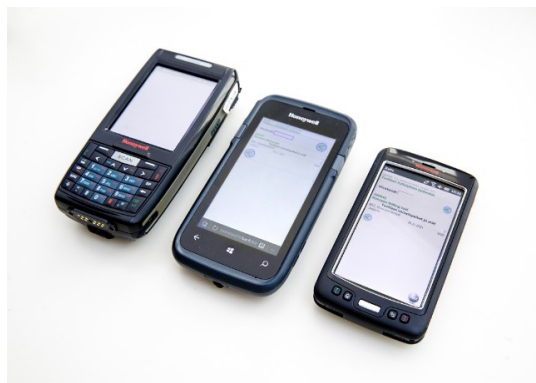
Kuva 1. Kannettava keräilylaitemallisto Honeywell Dolphin -malleja ja lääkkeen viivakoodin tunnistus.
